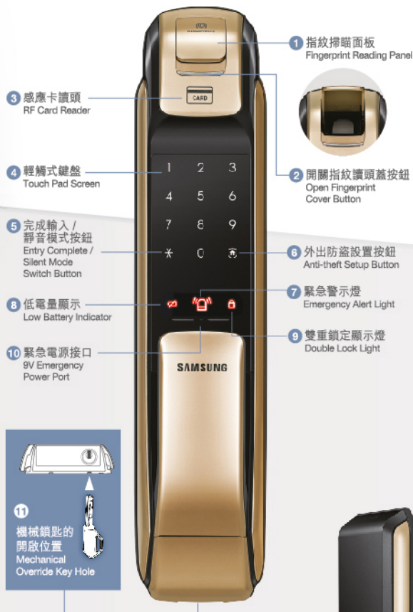
12 電池蓋 Battery Cover 13 關門鍵 Close Button 14 鹼性電池 x 8 AA (LR6) alkaline batteries 15 音量控制鍵 Sound Control Switch 16 自動/手動鎖定鍵 Auto/Manual Locking Switch 17 登記按鈕 Registration Button
