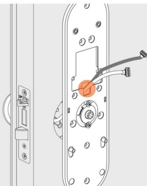
✓ 將後背板軸孔兩側的1號螺絲擰緊，固定背板。
