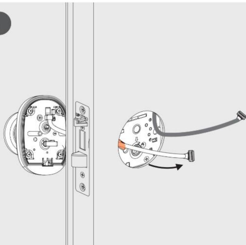
✓ 將室外機身連接軸對準鎖體的軸孔，將室外機身緊緊壓在門上。
