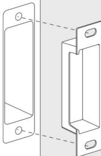
✓ 請將鎖口片的彎曲側面朝向室外方向。
