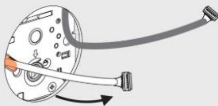
✓ 將室外機身電線穿過鎖體電線孔。
