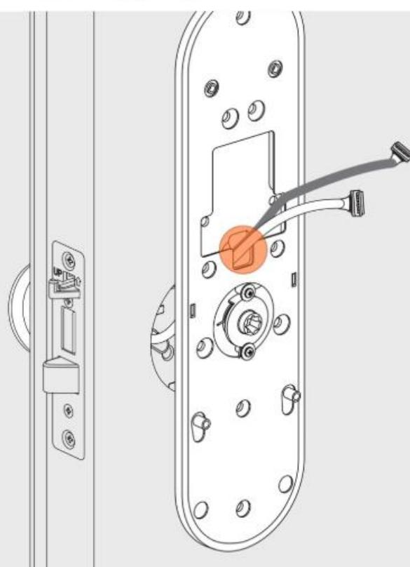
✓ 後背板軸孔兩側用1號螺絲擰緊，固定背板。
