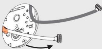
✓ 將室外機身連接軸對準鎖體的軸孔，將室外機身緊緊壓在門上。
